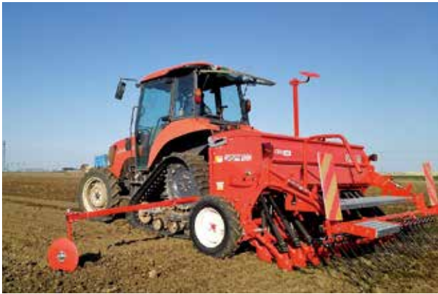
乾田直播では25条で播種し、約8時間の稼働で8haにまき終える
