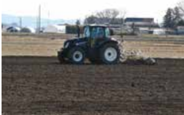
自動操舵システムを搭載したレーザーレベラー
