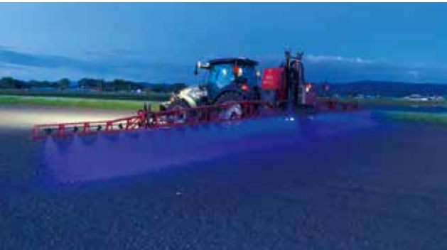
風の少ない夜間を実施するブームスプレーヤーでの防除作業(青色LED使用)
