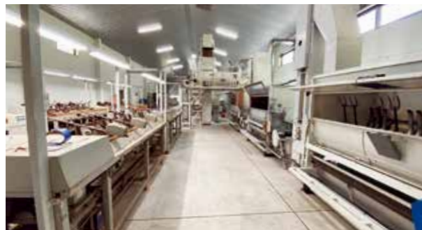
茶加工場の内部。蒸し・挟み・熱乾燥を行い、生葉を荒茶へ加工する
