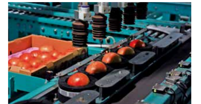
箱詰めロボットとモールドトレイの採用により胴打ちが減り、高速化とともに品質向上を実現
